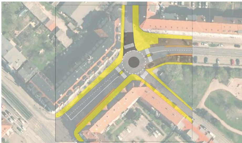
Abbildung 26: Knotenpunkt Robert-Beltz-Straße / Wossidlostraße / Max-Suhrbier-Straße mit einem Minikreisverkehr
